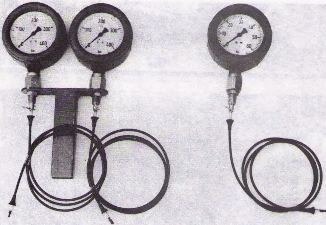
Zur kompletten Drucküberprüfung sind diese Prüfmanometer erforderlich.
