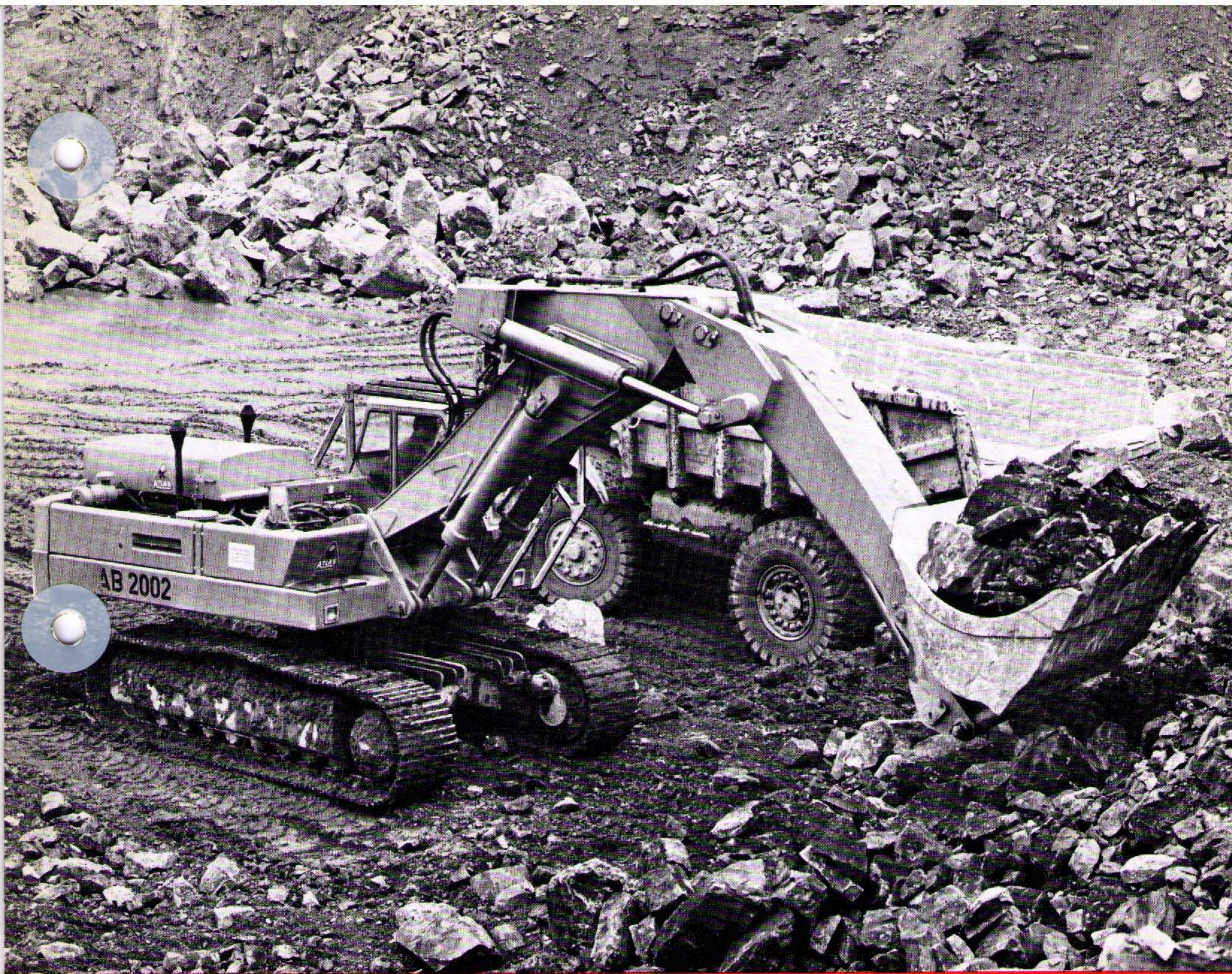
AB 2002 HD 350 t/h erzielte Umschlagsleistung mit Ladeschaufel
