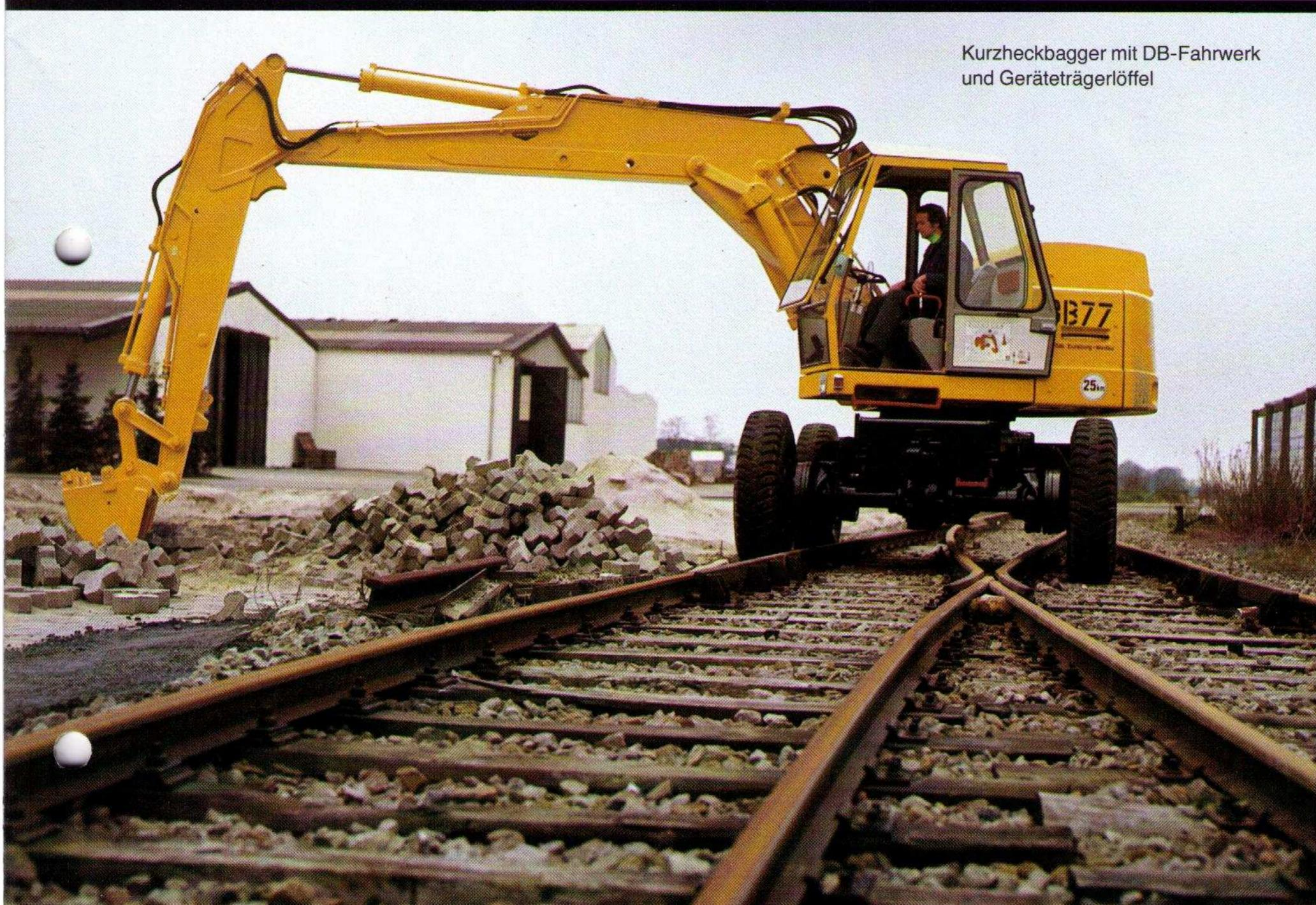
Kurzheckbagger mit DB-Fahrwerk und Geräteträgerlöffel
