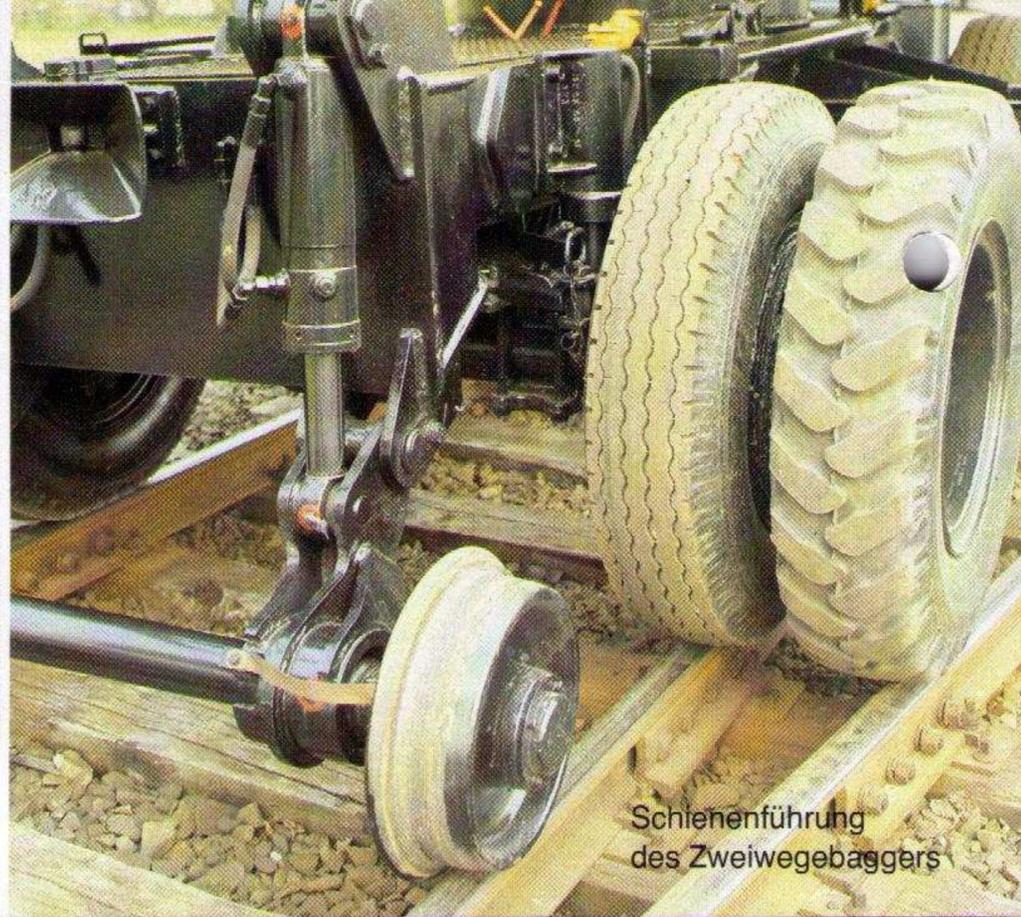
Zweiwegebagger in Fahrstellung auf der Schiene
