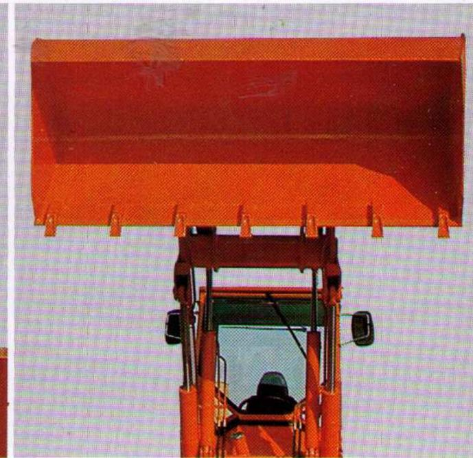
Max. Schaufelauskippwinkel in voller Höhe 48° für schnelle und vollständige Schaufelentleerung.
