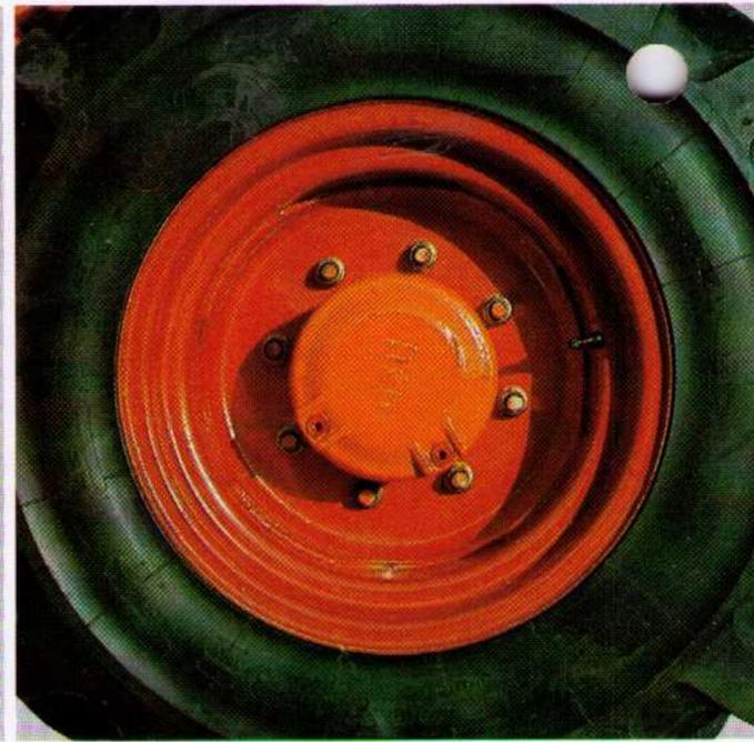
Geschlossenes Planetengetriebe in den Radnaben.
