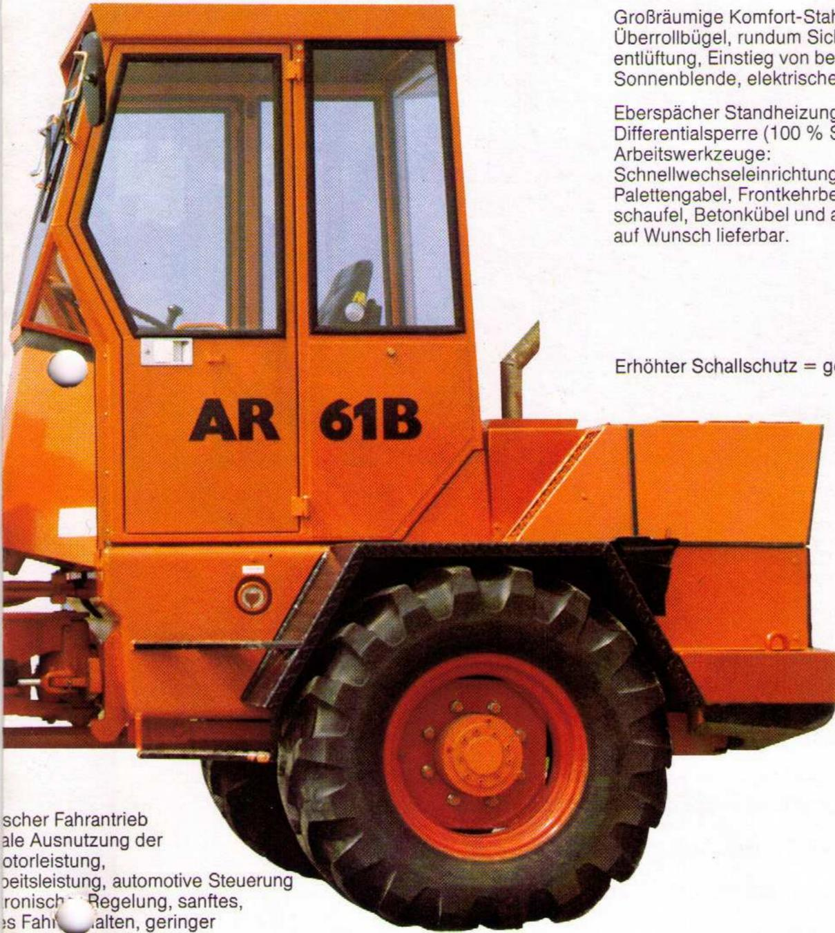
Großräumige Komfort-Stahlkabine, integrierter Überrollbügel, rundum Sicherheitsglas, Dachentlüftung, Einstieg von beiden Seiten, Sonnenblende, elektrischer Scheibenwischer.
