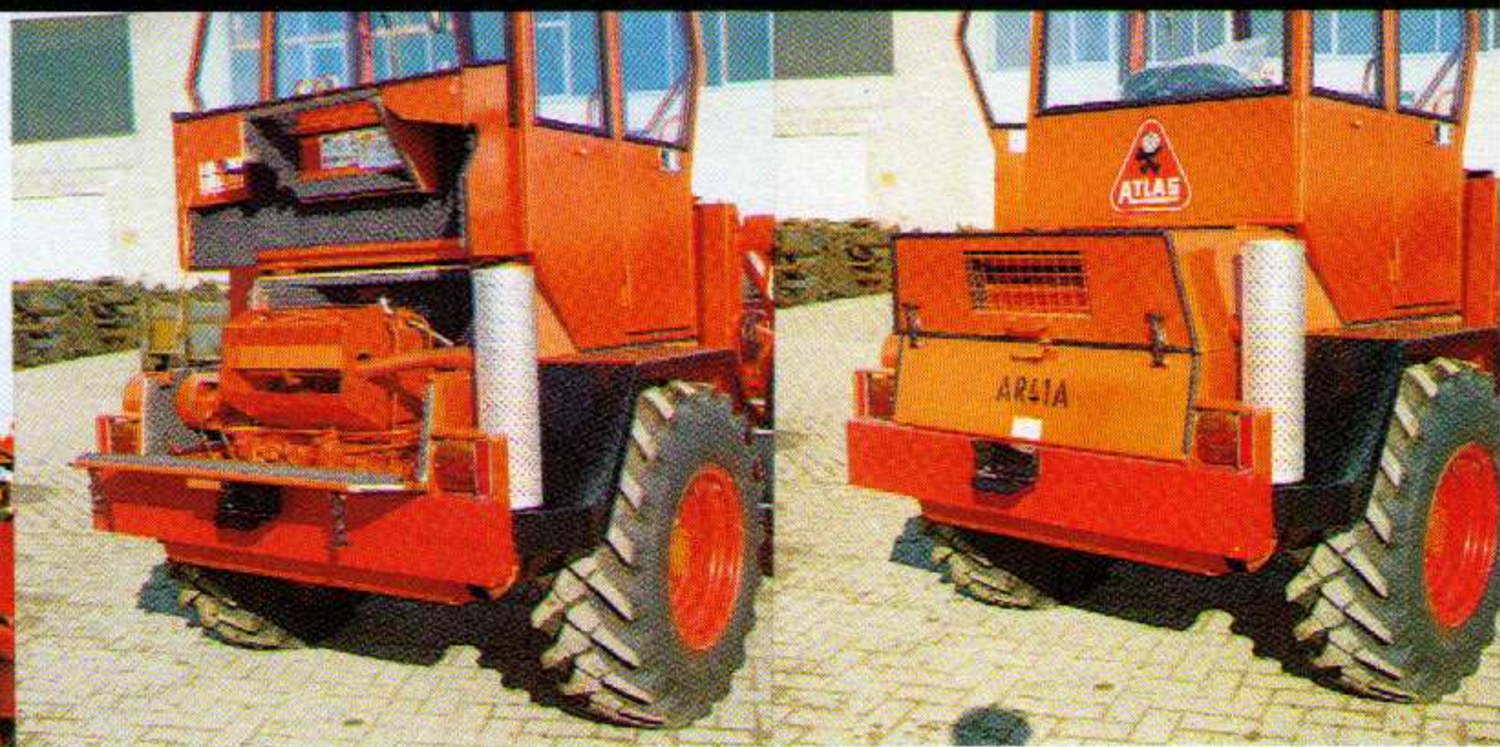
Leicht zugänglicher Motor; schallgedämpft
