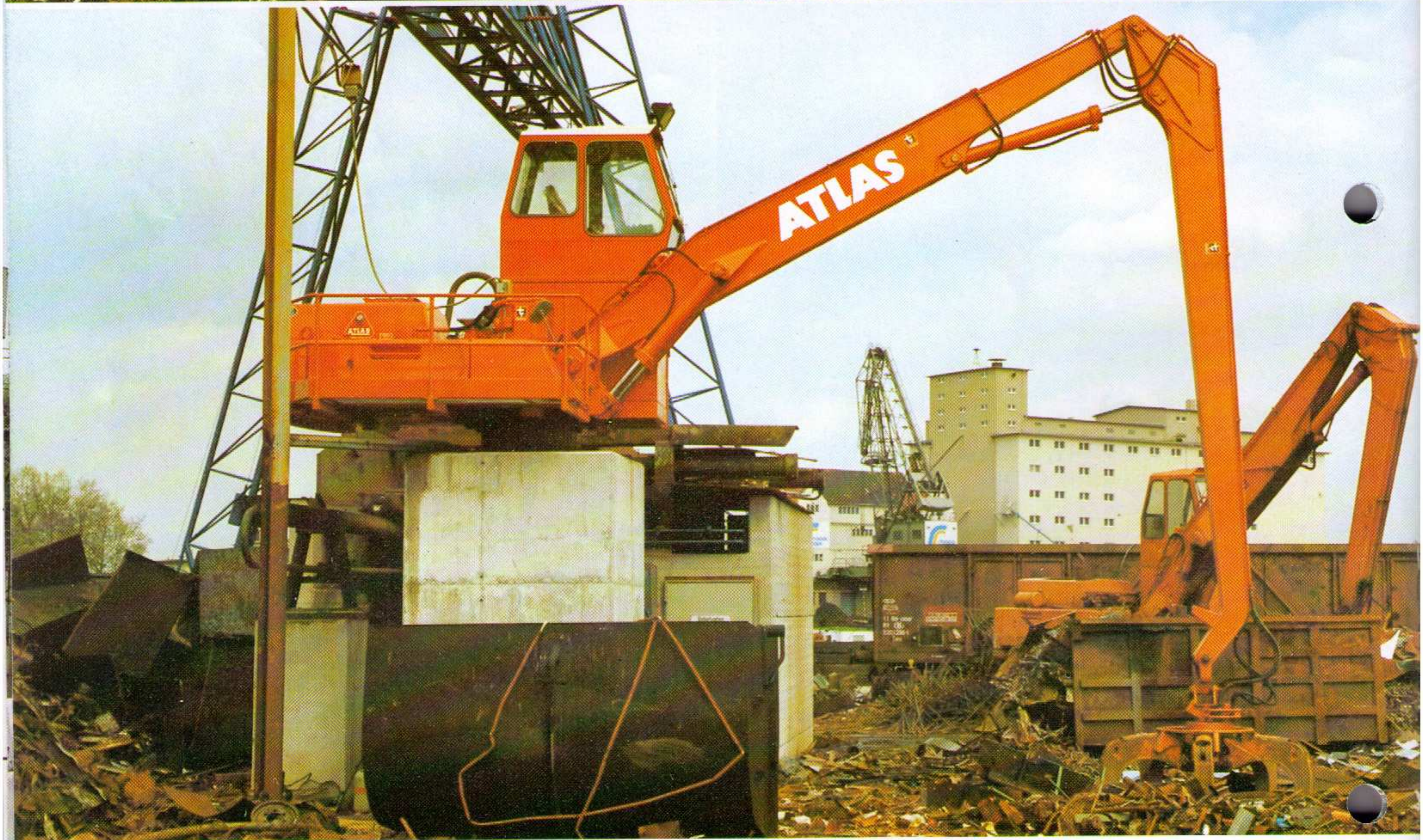
ATLAS 1802 Oberwagen stationär aufgebaut, Reichweite 21 m, Hubkraft an der Spitze 2,5 t. ATLAS 1604 Oberwagen und 1704 Mobil mit erhöhter Kabine.
