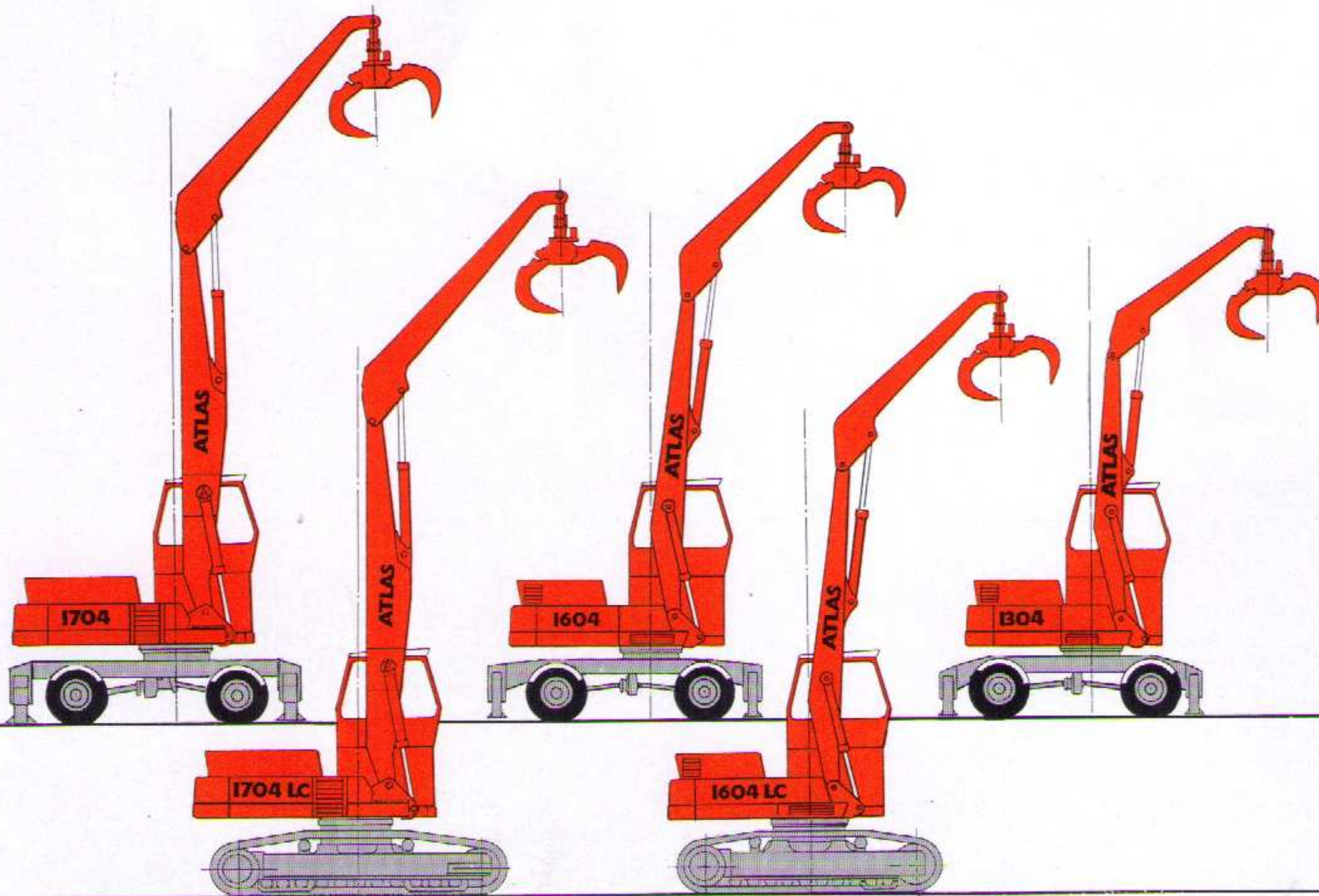
ATLAS-Hydraulikbagger auf Raupen- oder Mobilfahrwerk mit erhöhter Kabine.
