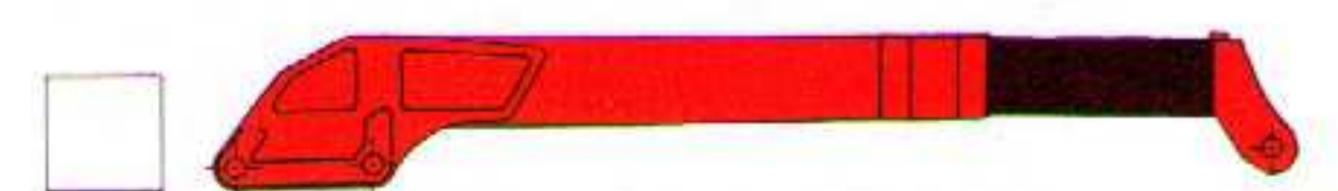
Nutzlänge 4000 mm plus 2800 mm hydr. Ausschub D 714
