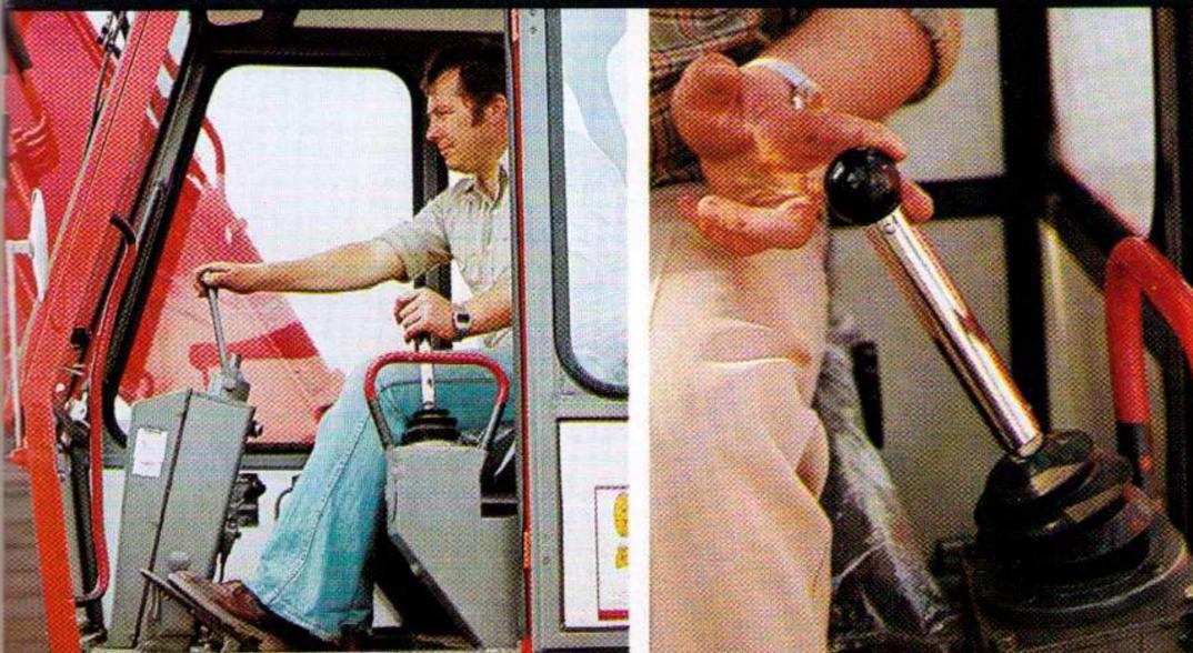
Die Bedienung ist einfach und logisch angeordnet. Die Kreuzhebelschalter für die Arbeitsbewegungen sind servogesteuert und darum spielerisch leicht und exakt zu bedienen. Die Steuerhebel für das Fahren vorwärts und rückwärts und für das Planierschild liegen direkt an der Steuersäule und sind bequem zu erreichen.
