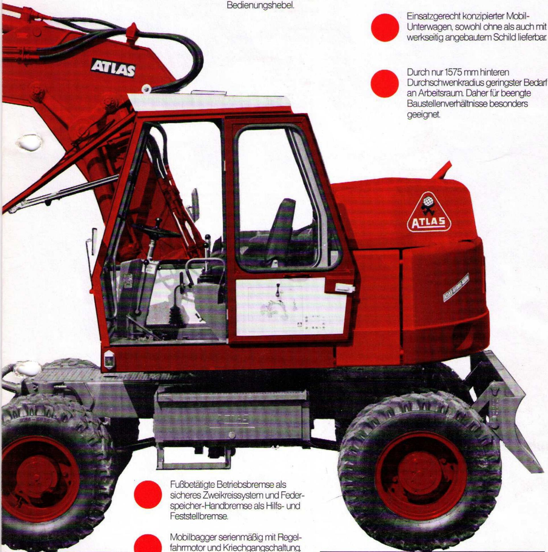
● Fußbetätigte Betriebsbremse als sicheres Zweikreisssystem und Feder-speicher-Handbremse als Hilfs- und Feststellbremse.
