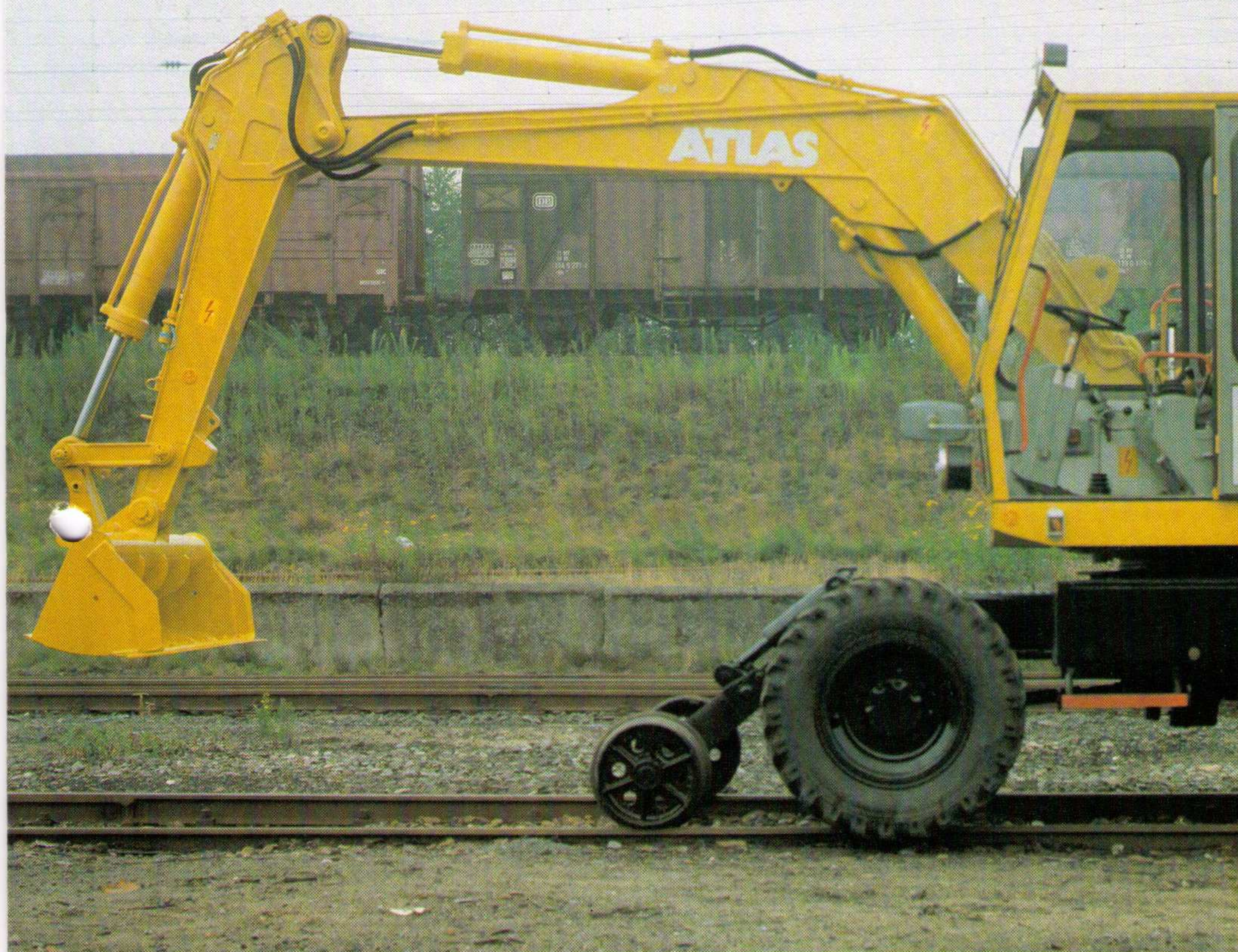
Der ATLAS 1122 D ZW beim Grabenräumen
