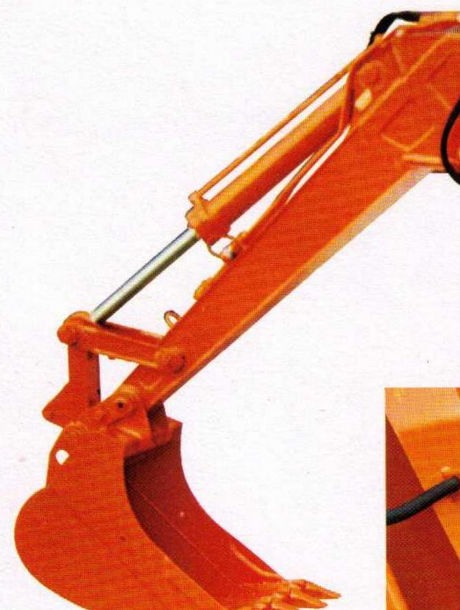
Max. 39 kN (3,9 Mp) Reißkraft und max. 46 kN (4,6 Mp) Losbrechkraft.
