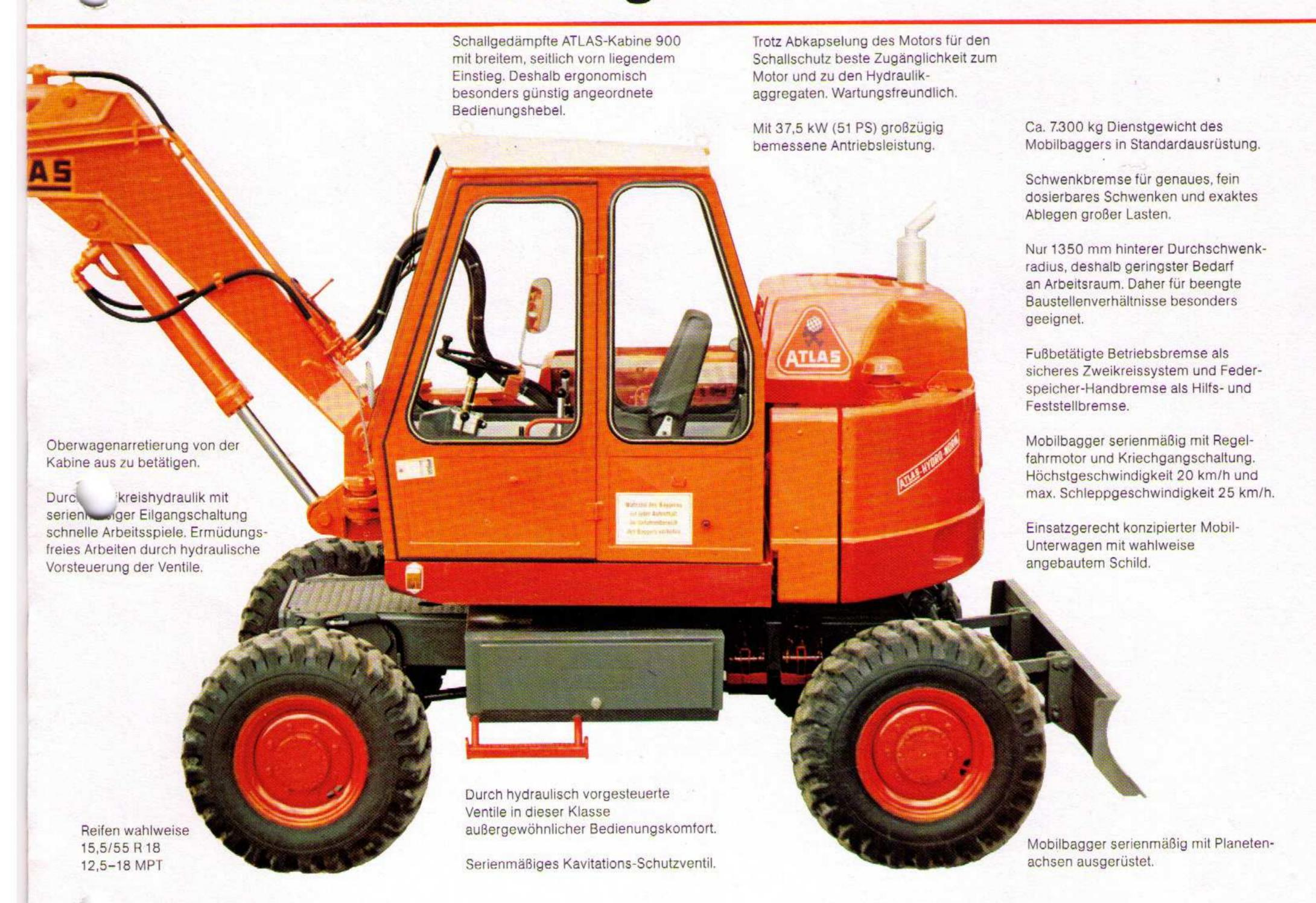
nrte ATLASt mit einem nur eren Der ATLAS erwagen, n ca. 55° nach links und rechts drehen. Der Drehpunkt ist aus der Mitte versetzt, und damit ist der ATLAS 1102 D in der Lage, mit dem 300-mm-Löffel an der Wand entlang zu baggern und die rechte Spur "frei zu schneiden". Durch die neuartige Anbringung des Auslegers wird der Graben lotrecht auf volle Tiefe ausgehoben. Nur
