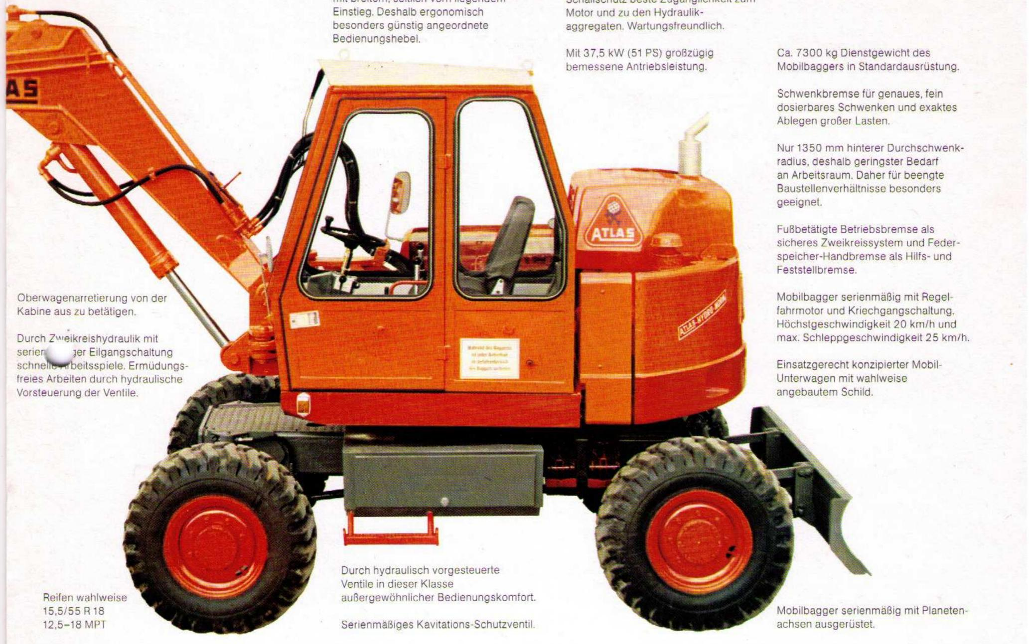
Schallgedämpfte ATLAS-Kabine 900 mit breitem, seitlich vorn liegendem Einstieg. Deshalb ergonomisch besonders günstig angeordnete Bedienungshebel.
