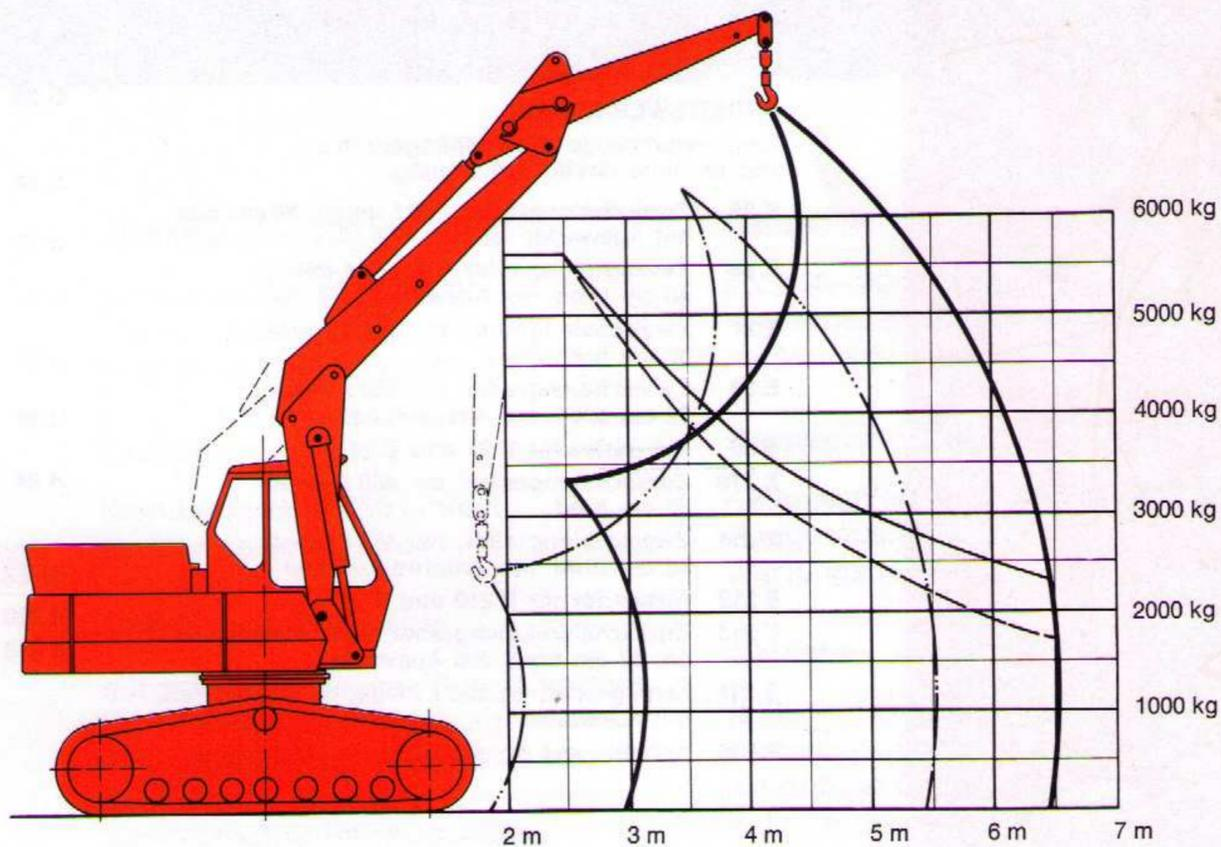
————— Traglast, Bagger in Längsrichtung
