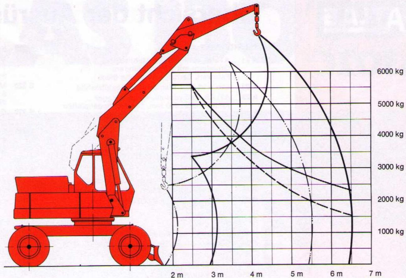
————— Traglast, Bagger in Längsrichtung
