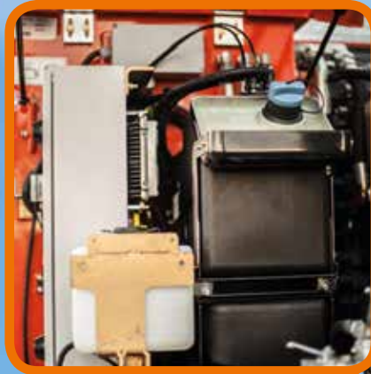
Leicht zugänglicher AdBlue®-Tank
