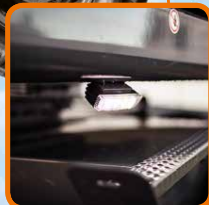
Sicherheitsleuchte für den Aufstieg
