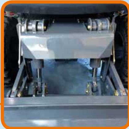
Schutz der Schläuche und Zylinder (Option)
