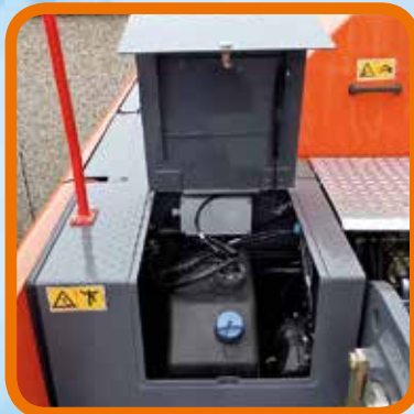
Leicht zugänglicher AdBlue® Tank
