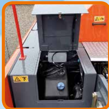
Leicht zugänglicher AdBlue® Tank
