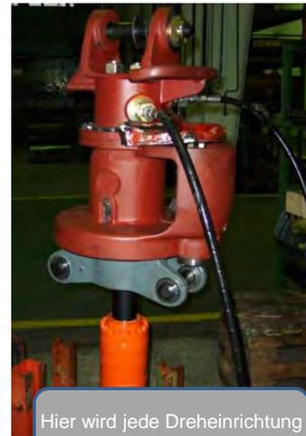
Hier wird jede Dreheinrichtung vor Auslieferung geprüft
