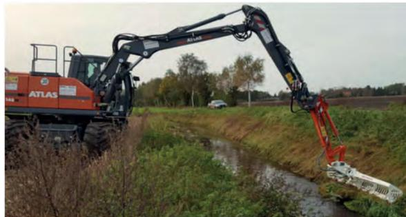
Die Aufnahmen (Korbräger) sind passend für das jeweilige Baggermodell oder die ggf. vorhandene Schnellwechseleinrichtung lieferbar. Auch Sonderabmessungen erhältlich. Unter zur Verfügungstellung der Kinematikdaten Ihres Baggers legen wir den optimalen Öffnungswinkel für den Mähkorb aus.
