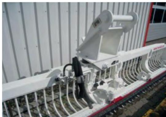
Der Korbräger ist pendelnd aufgenommen. Die Pendelbewegung wird durch zwei Gummipuffer gedämpft, daher ergibt sich eine gute Anpassung an die Bodenverhältnisse.
