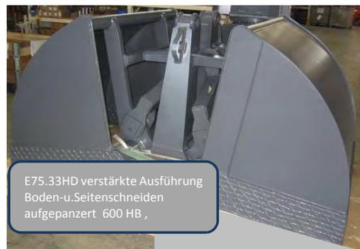
**Zweischalengreifer mit horizontalem Greiferzylinder
