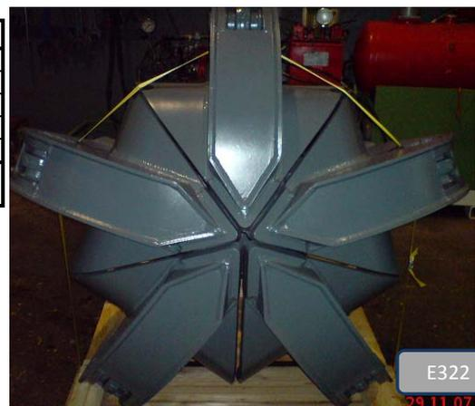
**Mehrschalengreifer mit 4 Greiferzylindern und Drehdurchführung
