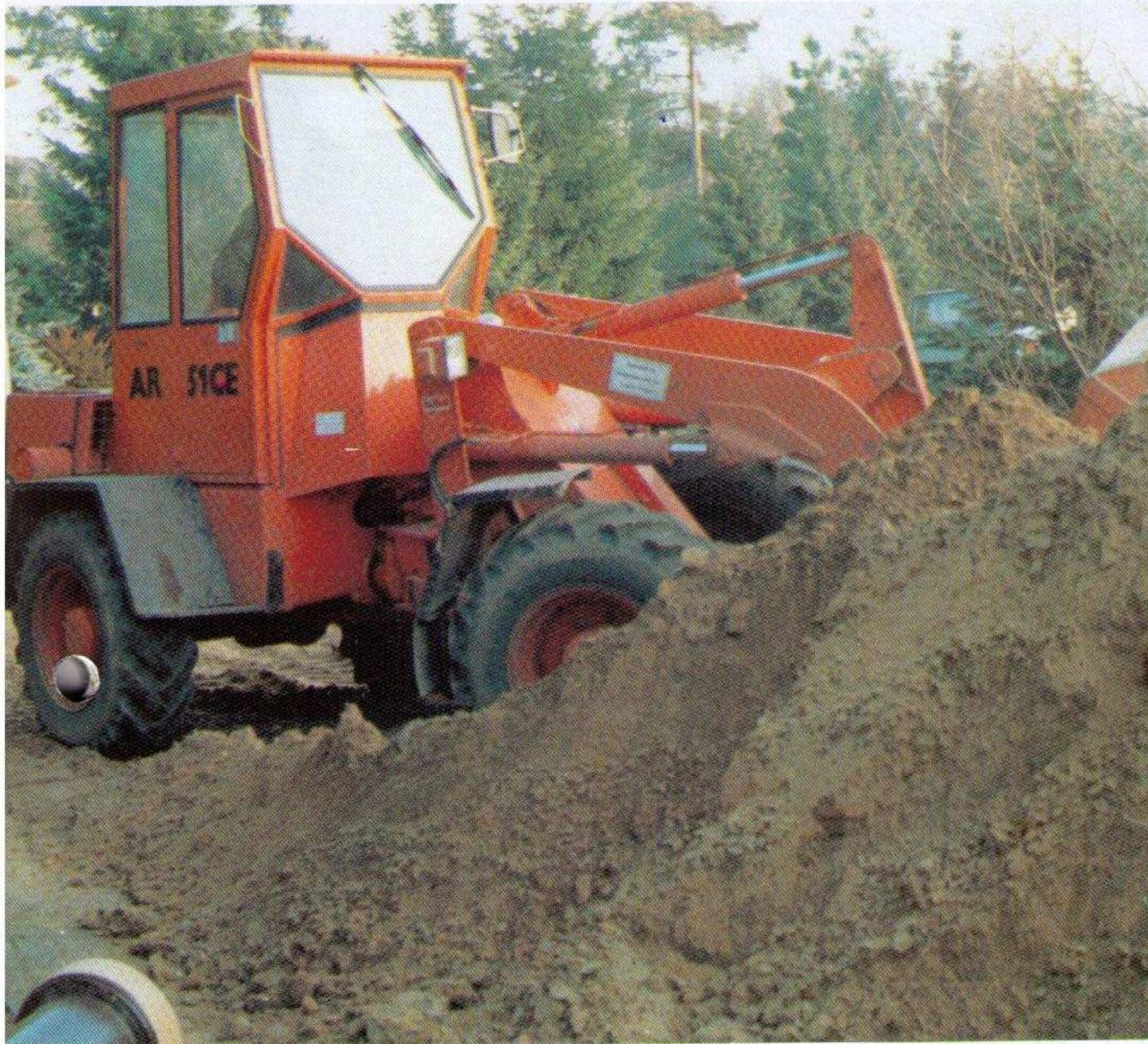
ATLAS-Radlader im Einsatz. Typische Kleinalader-Arbeit: Materialtransport, Grabenrückverfüllung, das Bewegen palettiertes Ware — Wasserrohre, SF-Steine, Randsteine. Hier in einem Wohngebiet. Da ist nicht nur wichtig, daß der Radlader wendig ist und leistungsstark, von besonderer Bedeutung ist auch der niedrige Schallpegel der arbeitenden Maschine.
