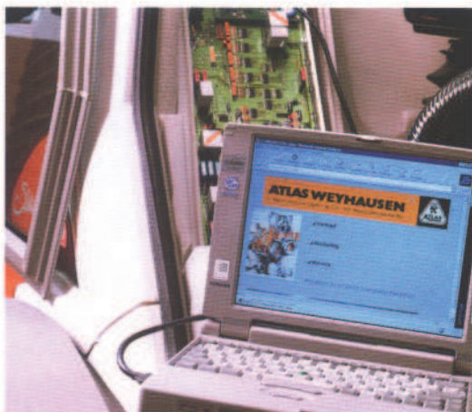
Service ADS ist eine Hilfe für den Service. Via CAN-Bus und Laptop zeigt es dem Mechaniker an: Drücke Einstelldaten, gespeicherte Fehlermeldungen und vorausgegangene Betriebszustände.
