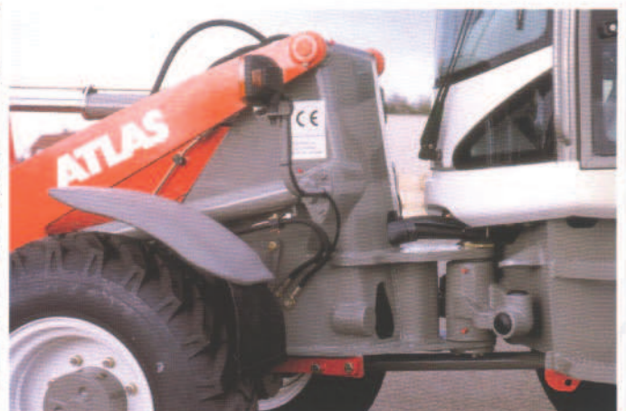
Knickpendelgelenk Gute Geländegängigkeit, hohe Nutzlasten durch tief liegenden Schwerpunkt.
