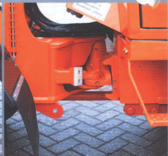
Knickpendelgelenk für gleichmäßige Traktion auf alle Räder.
