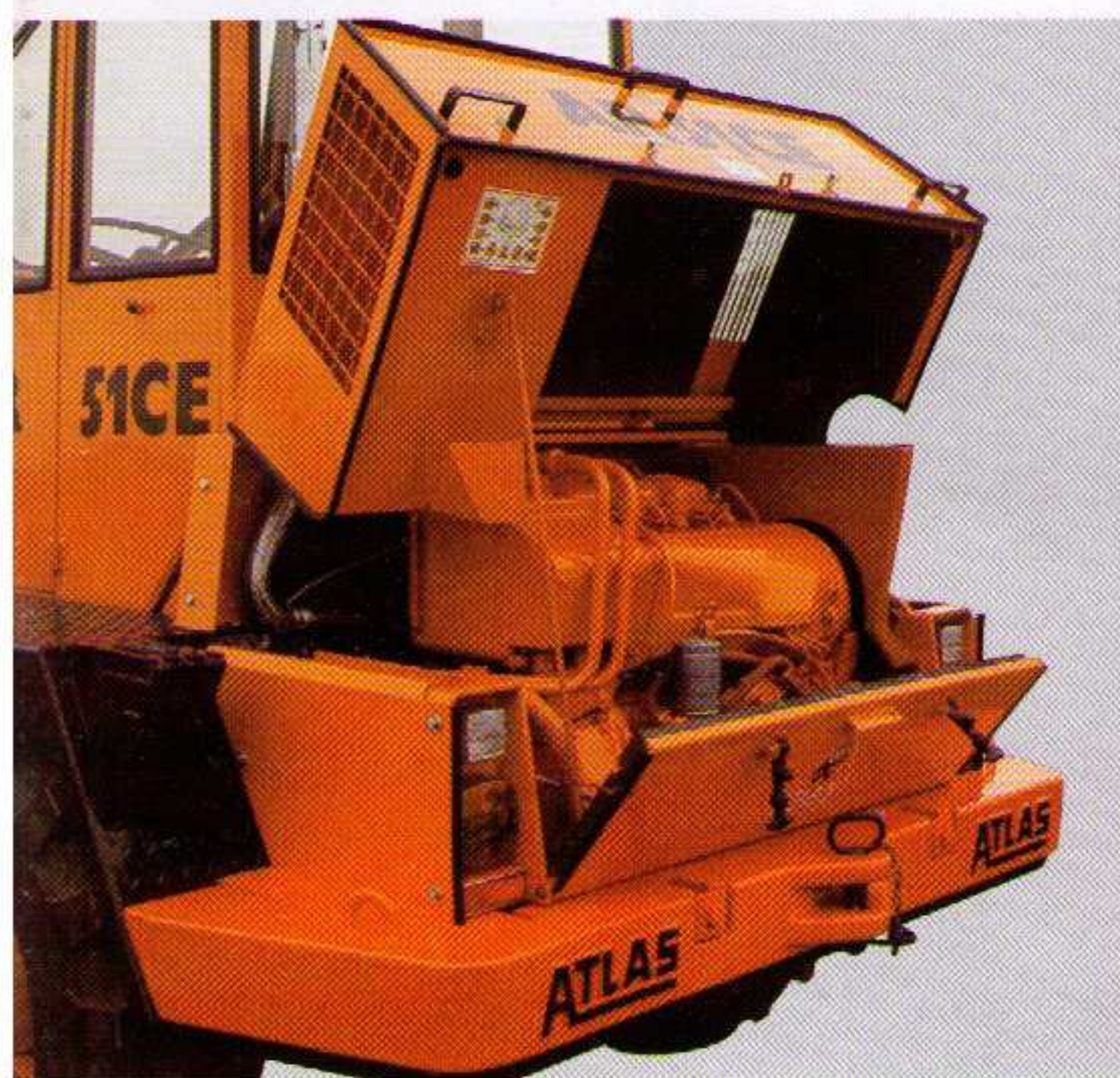
Für die große Inspektion Motorhaube steil aufklappbar.
