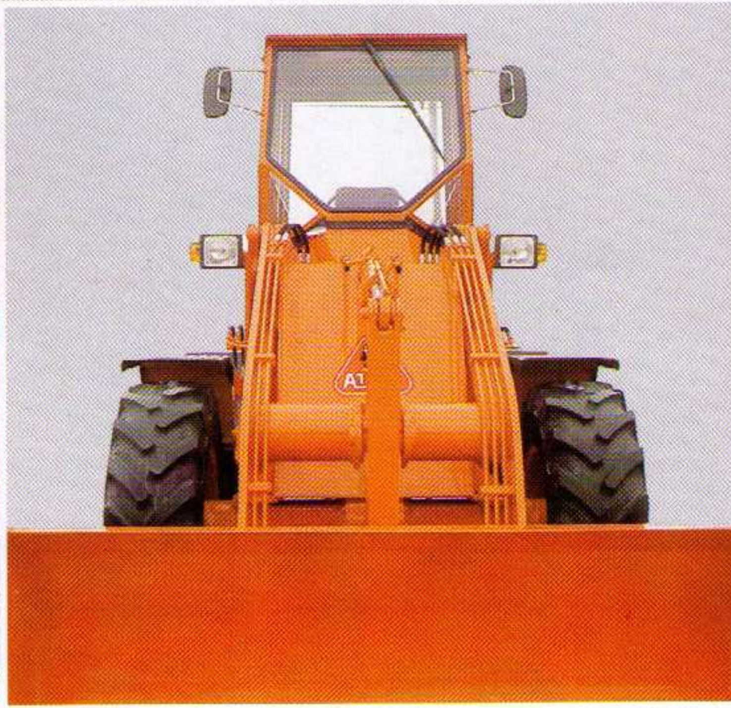
ROPS-Kabine mit ausgezeichneter Rundumsicht.
