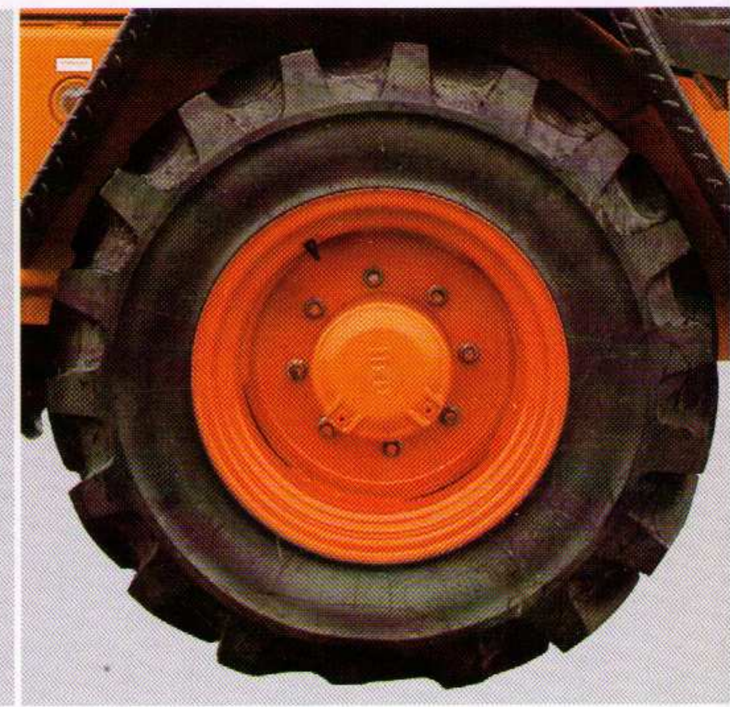
Geschlossenes Planetengetriebe in den Radnaben. Doppelt gelagerte Planetenbolzen.
