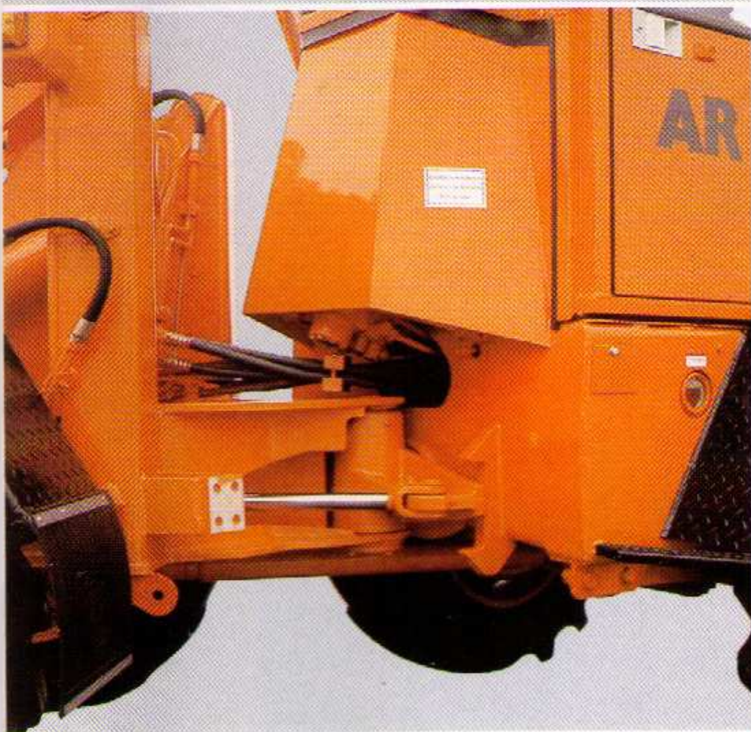
Gute Geländegängigkeit durch Knickpendelgelenk (Lagerung im Hinterwagen).
