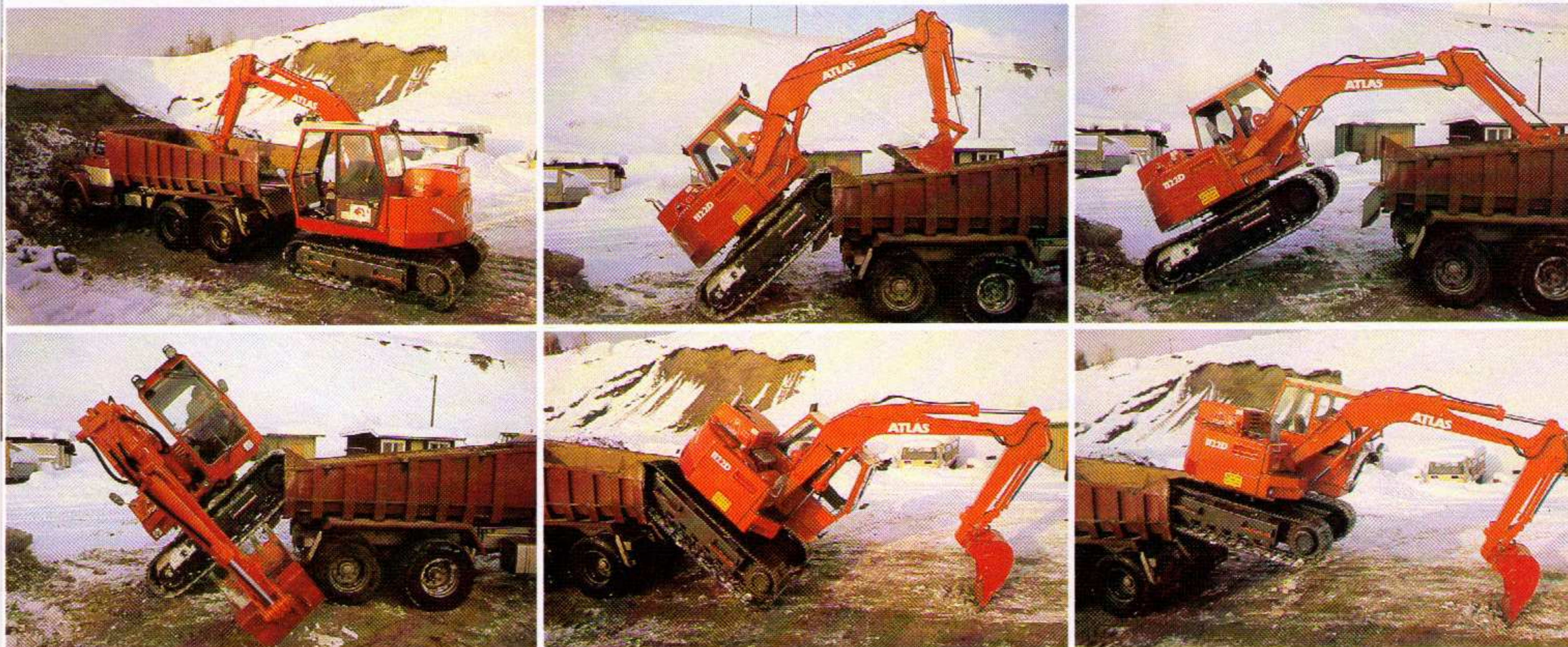
Diese Bilder zeigen, wie ein 1122 D Raupenbagger sich selbst auf einen Lkw verlädt
