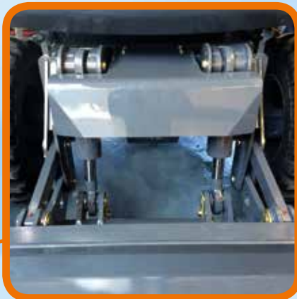
Schutz der Schläuche und Zylinder (Option)
