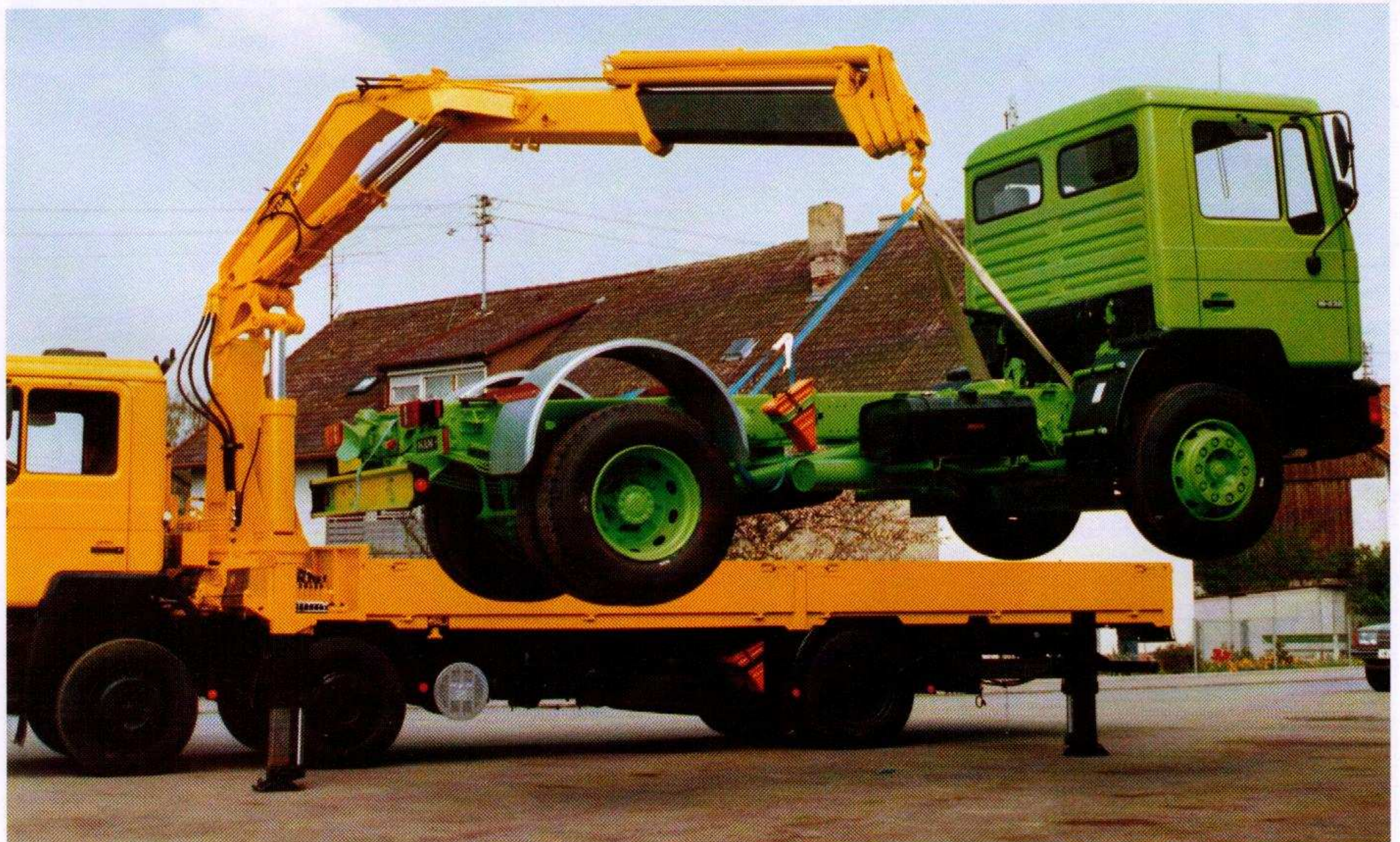
ATLAS LKW Ladekran 300.1 mit 12,4 m Reichweite.
