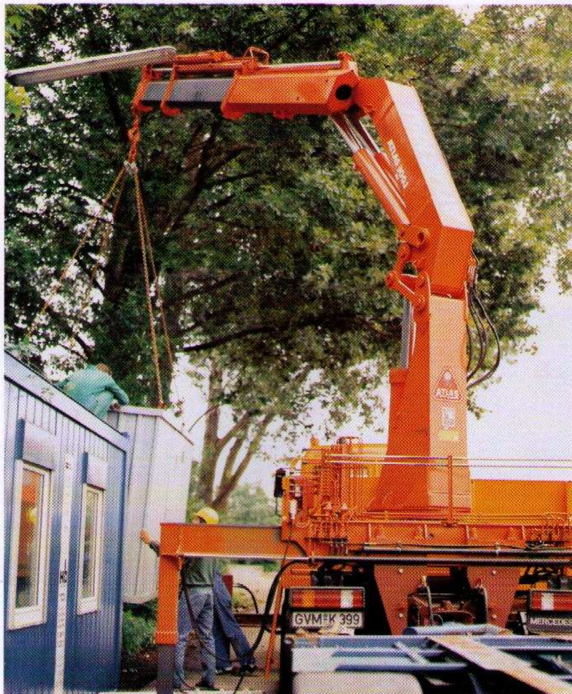
ATLAS LKW Ladekran 300.1 im Schwerlasteinsatz.
