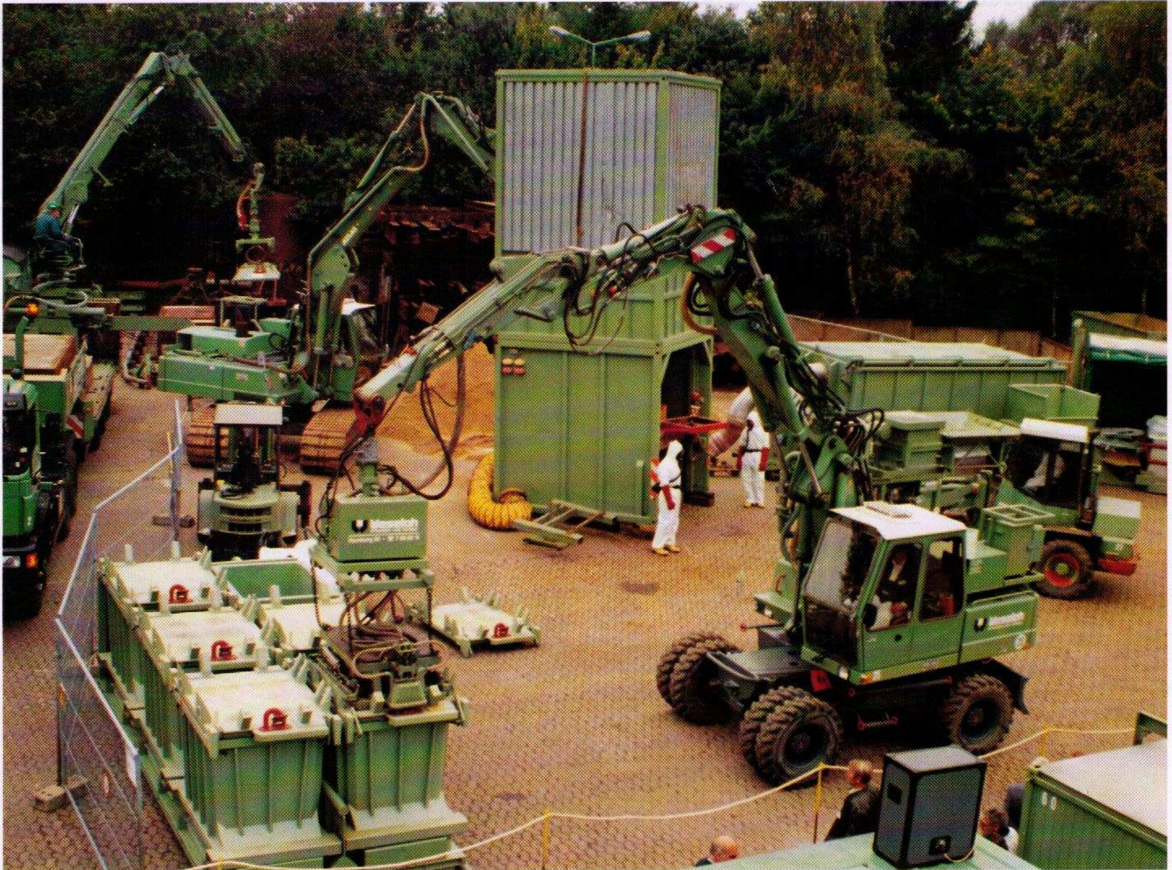
Handhabung kontaminierter Stoffe mit dem WESELOH-System und ATLAS Geräten.
